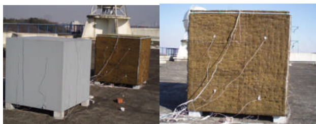
図-1 実験装置設置風景 図-2 熱電対設置風景
